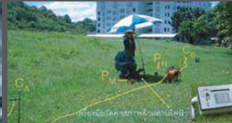
การใช้วิธีสำรวจทางธรณีฟิสิกส์ด้วยการวัดค่าสภาพต้านทานไฟฟ้าเชิง 2 มิติ (2D resistivity imaging) โดยใช้วิธีปล่อยกระแสไฟฟ้าแบบขั้วลบเบอร์เจอร์ (Schlumberger configuration)
